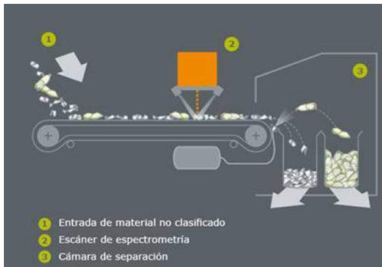
A continuación se muestra el diagrama de flujo de funcionamiento de la planta de selección:
